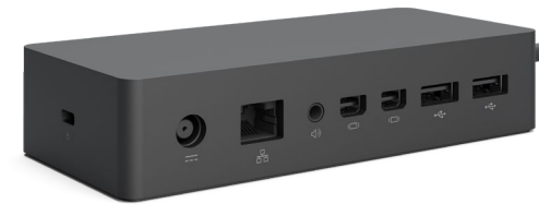
Surface Dock – SKU: PF3-00006 4 × USB 3.0 (2 × Front, 2 × Rückseite), 1 × Gigabit Ethernet, 1 × 3,5mm-Audioeingangs-/Audioausgangsanschluss, 2 × Mini-DisplayPort, Sicherheitsschloss, kompatibel mit Surface Pro 4 und Surface Pro 3
